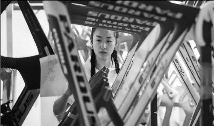
7월 8일, 산둥성 태산서표복합재료회사 생산작업장에서 한 일군이 탄소섬유 자전거 프레임(车架)을 점검하고 있다. / 신화넷
